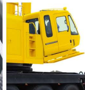
▲15°までのチルト式。スライド式ステップの採用でキャブへの乗り込みが楽になりました。
